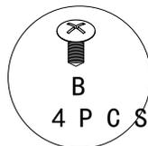
図のように4ヶ所をB タッピングビスで90度を確保して固定して下さい。
