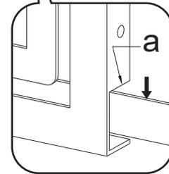
前枠a部を底板のふちに引っ掛けるようにします。
