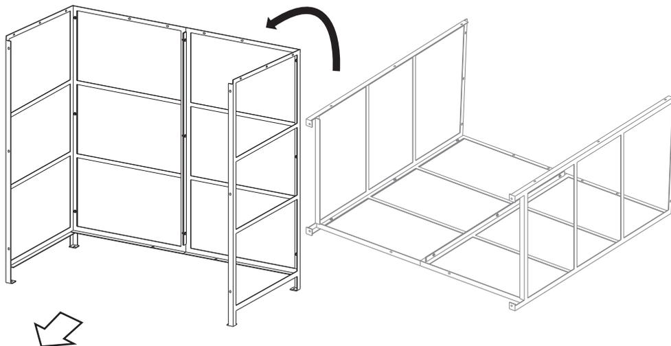
②2分割の底板を立てて持ち、左右底板を左右に少し斜めにしながら、本体の内側に入れ込みます。
