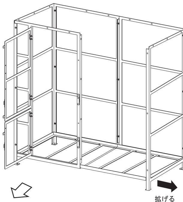
②前枠右を持ち上げ、前枠a部を右底板に乗せるようにします。
