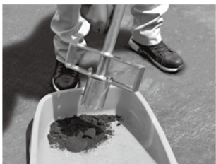
円筒刃内部に入った土はレバーを踏んで押し出します。
